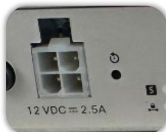
**Vérifier que l'alimentation est bien branchée (prise électrique + port d'alimentation du routeur)**
